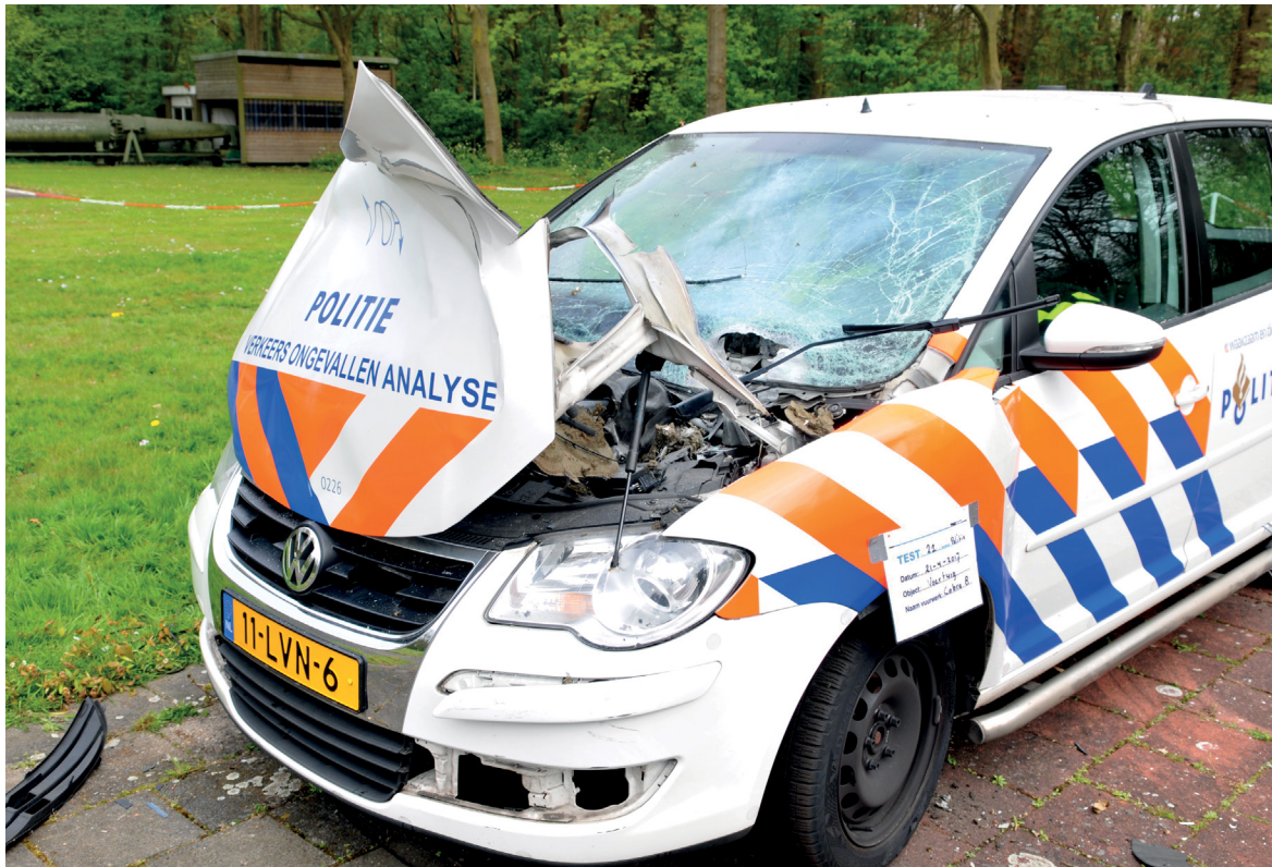
Figuur 13: Schade aan politievoertuig door een Cobra 8. (Foto: TNO)
